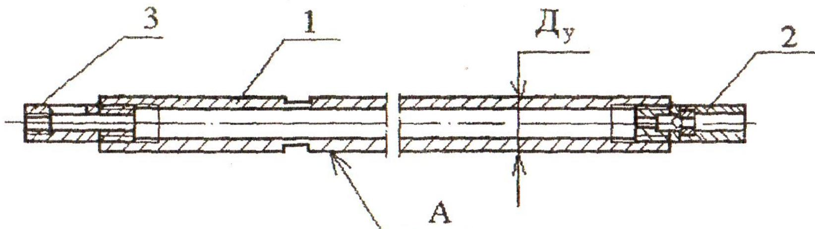
1 – плунжер; 2 – узел нагнетательного клапана; 3 – клетка
