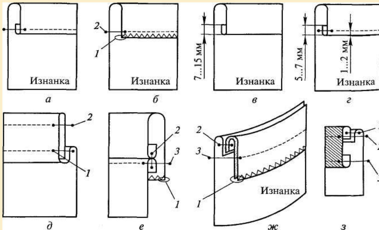
Рис. 4. Обработка верхнего края накладного кармана
