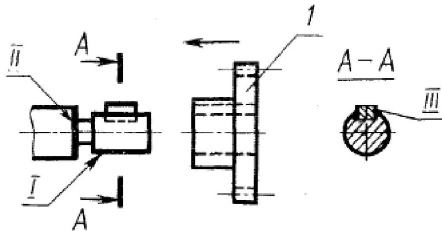
*I, II, III* — один из комплектов вспомогательных баз вала со шпонкой; *I* — присоединяемая деталь
