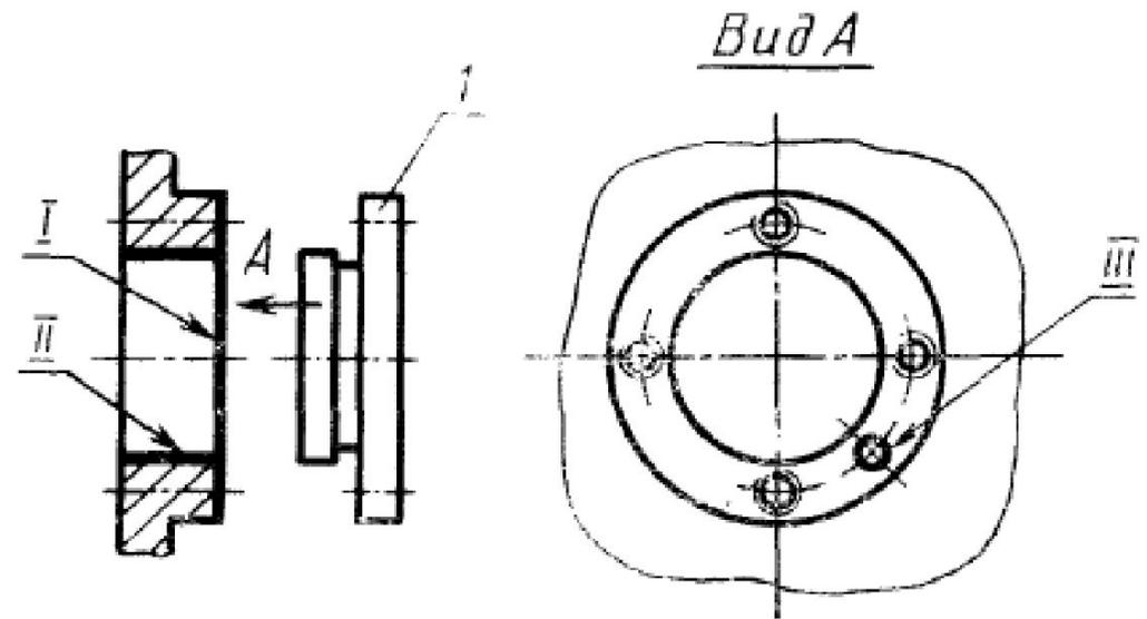
*I, II, III* — один из комплектов вспомогательных баз корпуса; *I* — присоединяемая деталь.
