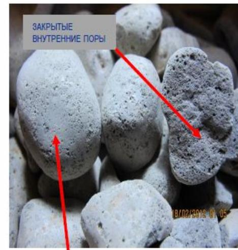
Шероховатая и частично открытая наружная поверхность стеклянных гранул накапливает жидкость, обеспечивая улучшение сцепления цементного камня.
