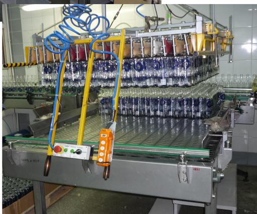
Предназначен для разгрузки бутылок с паллет и подачи их в конвейерную систему транспортировки бутылок к технологическому оборудованию.
