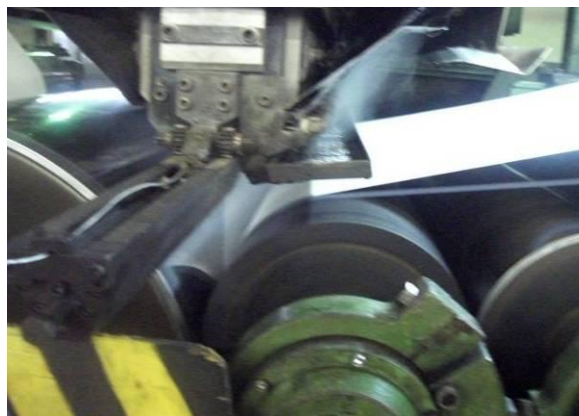
Линия пролива полимером композитного материала. Защита приводного ремня от налипания полимера - 5491 3М
