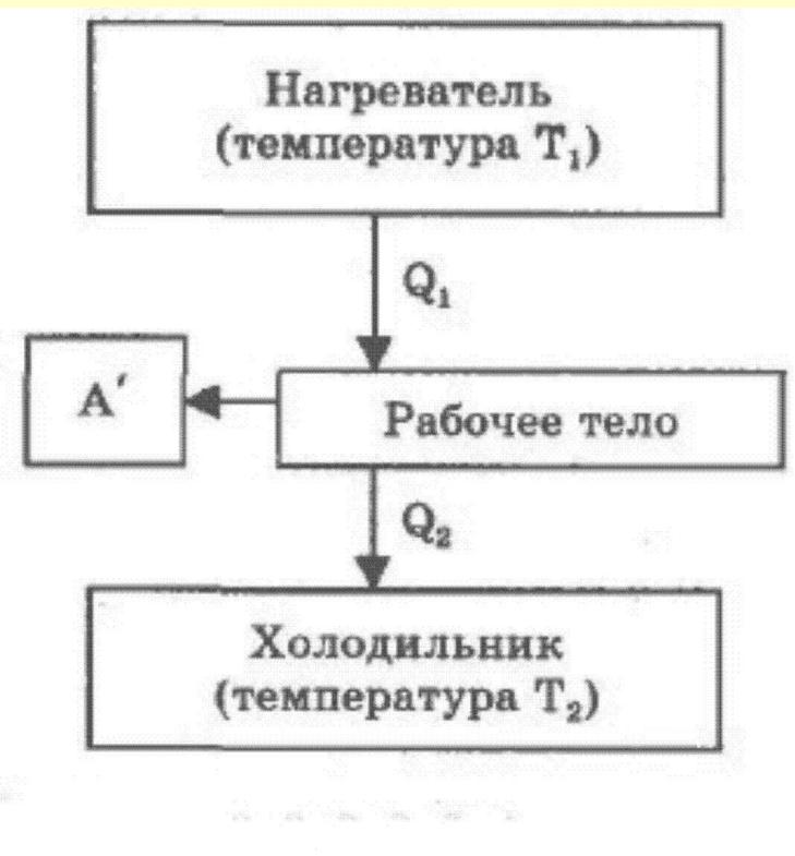
Теплоемкость каждого источника столь велика, что отъем рабочим телом теплоты от одного источника и передача его другому практически не меняет их температуры.
