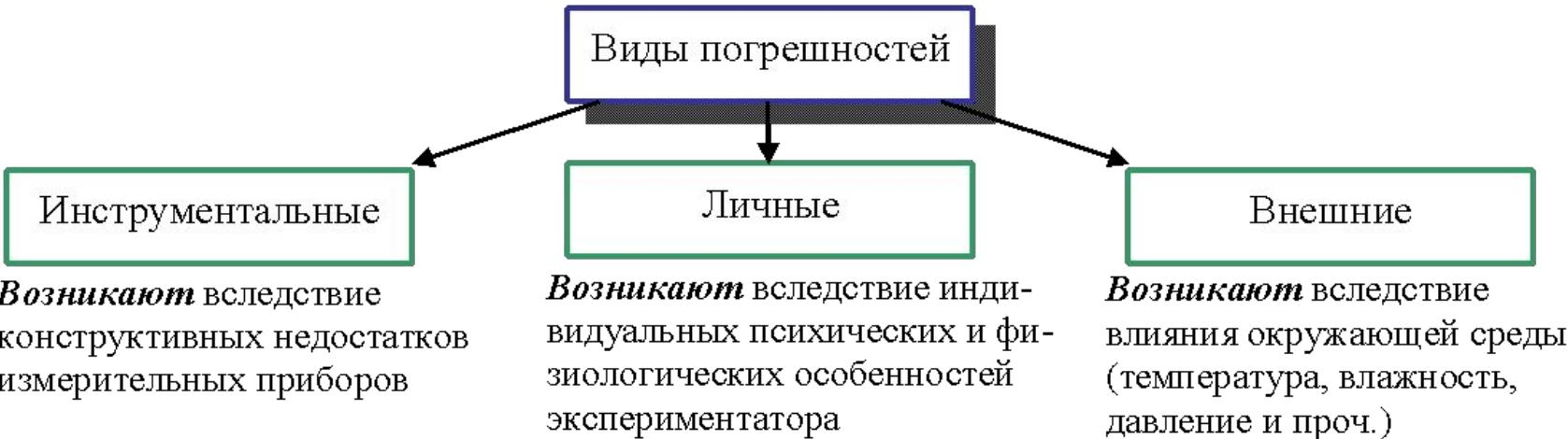
Точность измерительного прибора оценивают **классом точности**, который характеризует приведенную погрешность прибора. Различают восемь классов точности измерительных приборов: 0.05, 0.1, 0.2, 0.5, 1.0, 1.5, 2.5, 4. Численное значение класса точности характеризует приведенную погрешность измерительного прибора в процентах.
