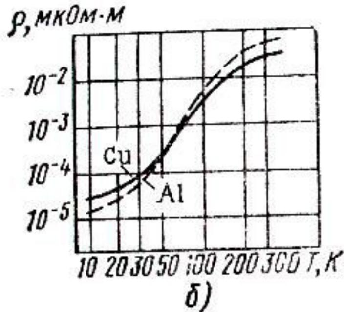
Зависимости удельного сопротивления от температуры в широком интервале температур для меди (а) и при низких температурах для меди и алюминия (б)
