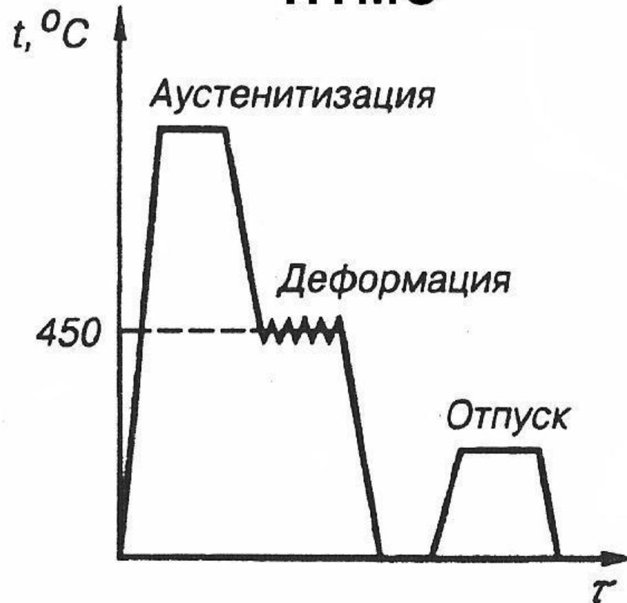
Рис. 36. Схемы термомеханической обработки стали
