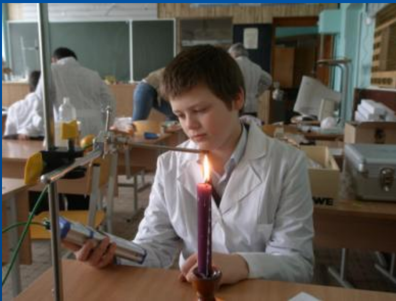
Фото 10. Работа с оборудованием фирмы RHYWE с датчиком температур и термопарой. Определение температуры пламени парафиновой свечи.
