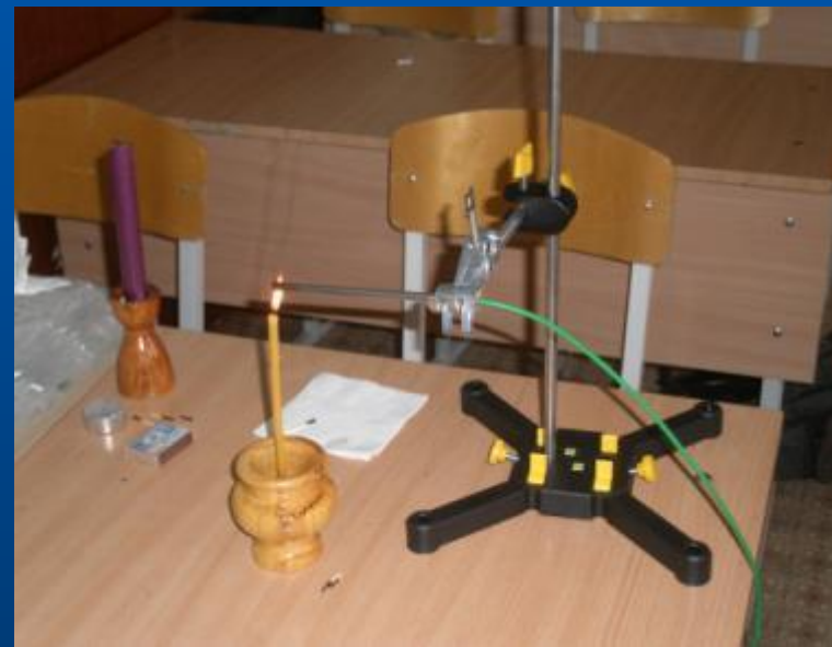
Фото 11. Работа с оборудованием фирмы RHYWE с датчиком температур и термопарой. Определение температуры пламени восковой свечи.
