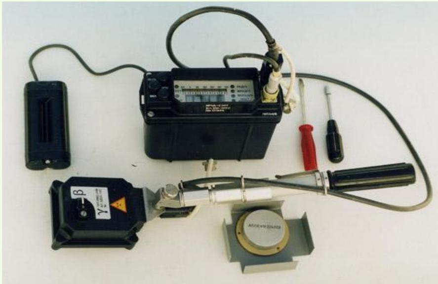
Предназначен для определения мощности поглощенной дозы гамма-излучения, определения степени загрязненности поверхностей бетаактивными веществами (плотность потока).
